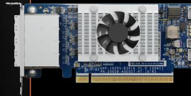
SAS拡張カード(QXP-820S-B3408)は、QNAP TL SAS JBODシリーズストレージ拡張デバイスと組み合わせてNAS用に特別に設計されています。16ベイTL-R1620Sep-RP SAS JBODを最大16台まで接続でき、多目的なストレージソリューションを提供します。
