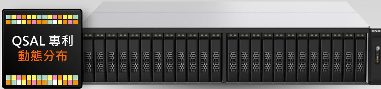
QSAL (QNAP SSD Anti-wear Leveling) 可以在SSD壽命超過50%後，開始動態調整SSD OP以達到每顆SSD的壽命能夠精準控制，並都能夠在SSD壽命終止時確保有足夠的rebuild時間來避免RAID損壞。
