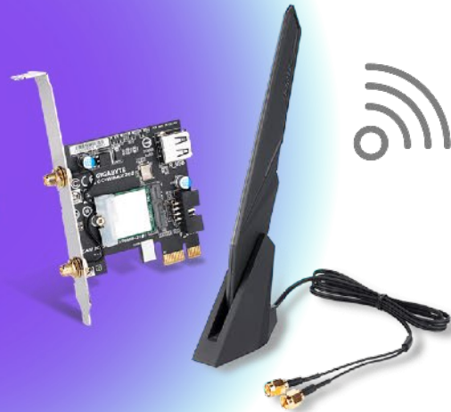
PC / NAS 安裝 QXP-W6-AX200 PCIe WiFi 6 無線網卡
